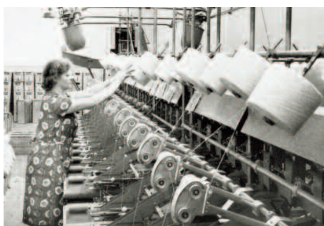
Blüte der Textilindustrie: Arbeiterin an einer automatischen Schusspulmaschine der Textilfirma Heinrich Maschmeyer in Schüttorf. Aufnahme von 1967. (Foto: Volker Wurster/Archiv des Landkreises Grafschaft Bentheim)
